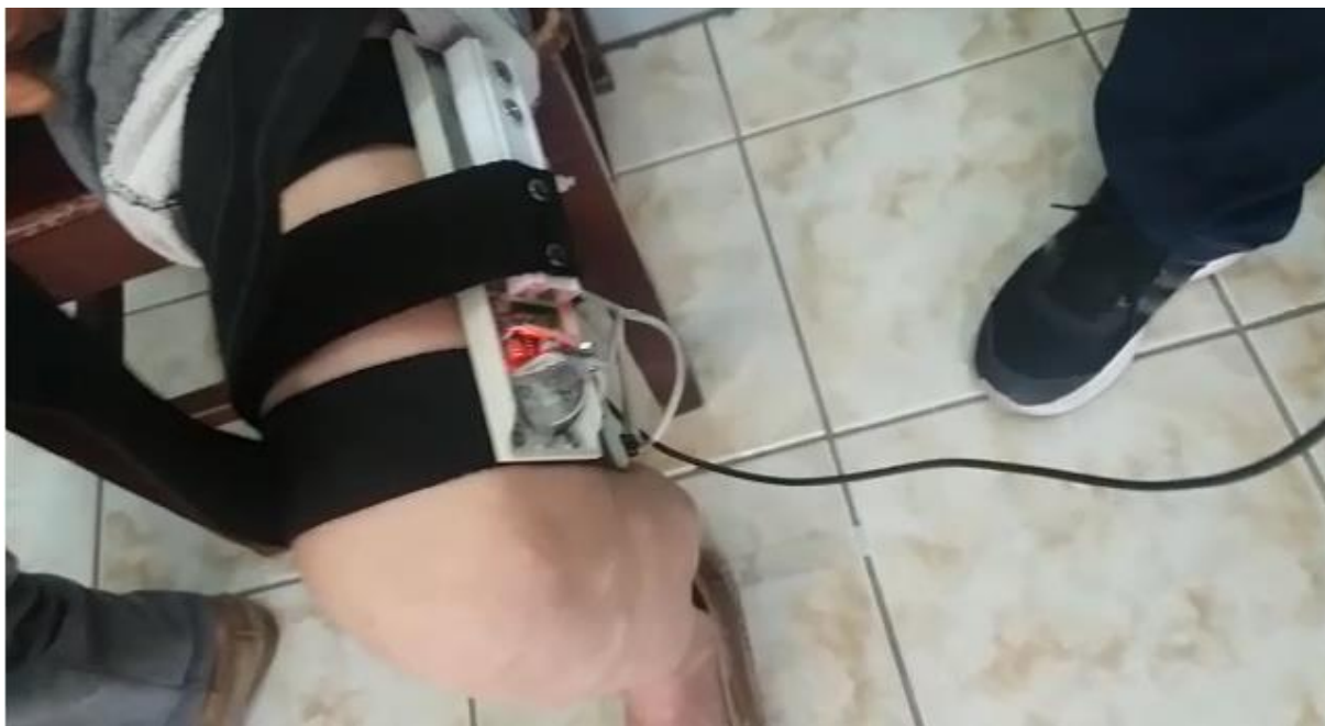
Figura 11 - Demonstrativo da colocação do sensor acoplado ao computador, em perna esquerda do idoso sentado, antes do início da caminhada para fazer o teste
