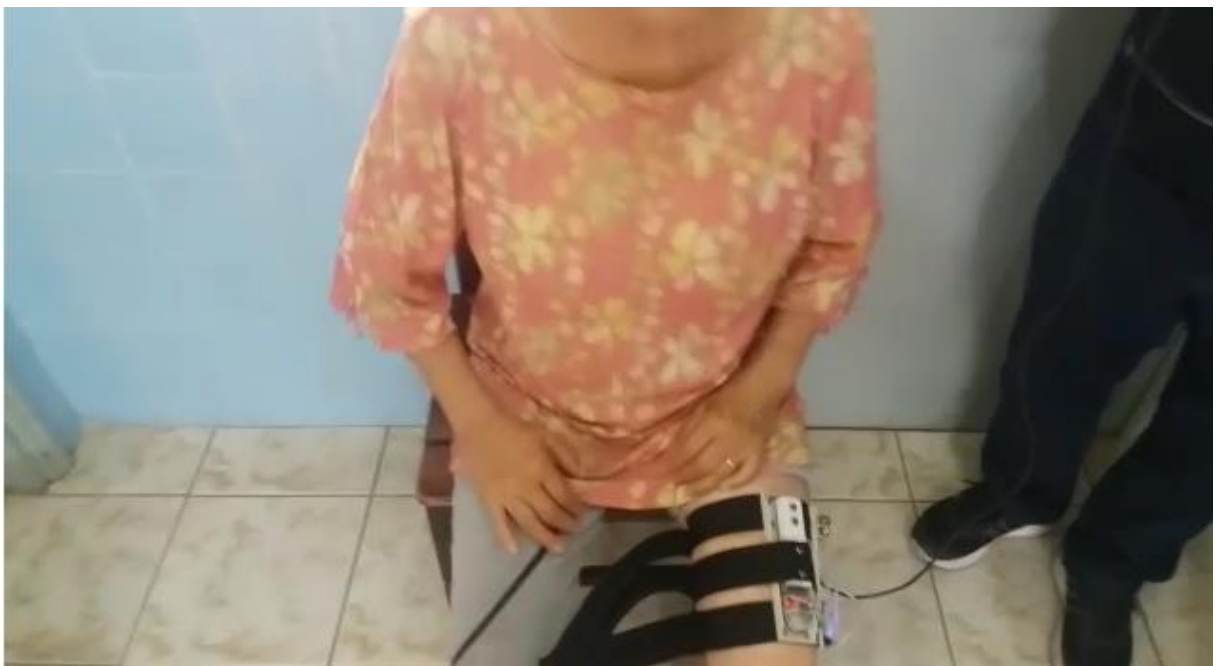
Figura 14 - Demonstrativo da colocação do sensor acoplado ao computador, em perna esquerda da idosa sentada, antes do início da caminhada para fazer o teste
