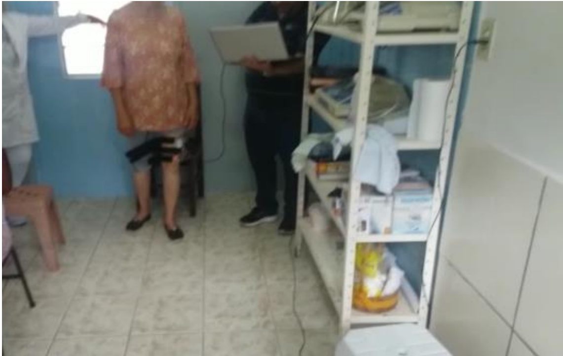
Figura 15 - Demonstrativo do sensor acoplado a um computador, em perna esquerda da idosa em posição ortostática para o início da caminhada para fazer o teste
